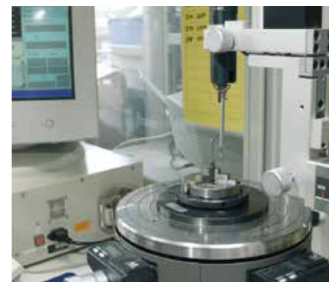
Messung des Innendurchmessers eines eingepressten Gleitlagers Measurement of the inner diameter of a pressfit plain bearings
